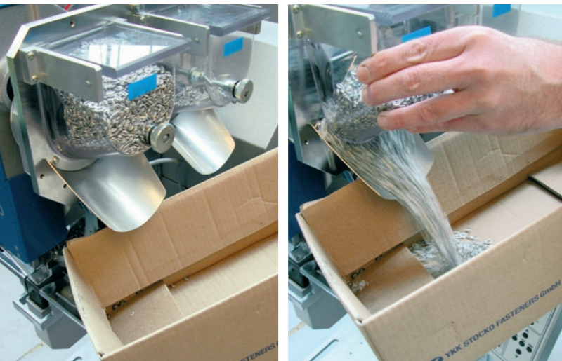
Schnellentleerungssystem der Artikelmagazine Transparente Artikelbehälter Quick-emptying system for the hopper system Transparent hoppers
