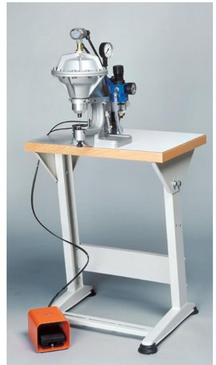
Abgebildete Ansetzmaschine ausgerüstet mit Sonderzubehör (Maschinentisch)
